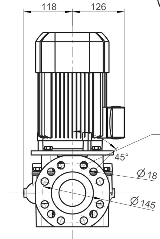
Flansch gebohrt nach DIN 2633
